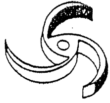
(a) پره باز (زمانی که مواد و ناخالص همراه سیال پمپ شود)
